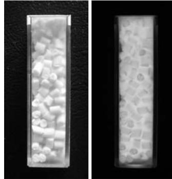
Abbildung 4: Cuvetten mit phosphoreszierendem Material Storelite®; links: bei Tageslicht, rechts: in der Dunkelheit
